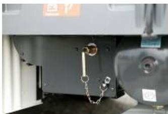
Выключатель "массы" аккумуляторной батареи, техобслуживание.
