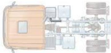
Отвод отработавших газов, направленный назад (04074)
