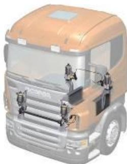
4-точечная подвеска кабины – пневматическая
