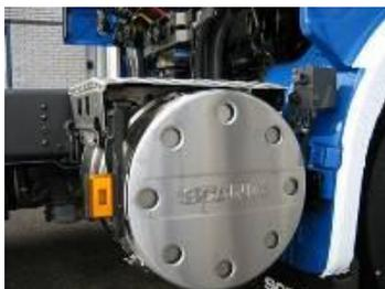
Торцевая термозащита для цилиндрического глушителя на автомобилях без защитного ограждения или бокового противоподкатного ограждения.
